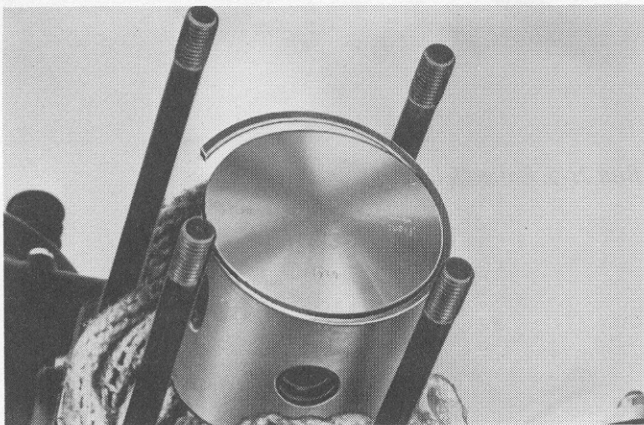
Bild 21-9. Skydd av vevhusöppning
